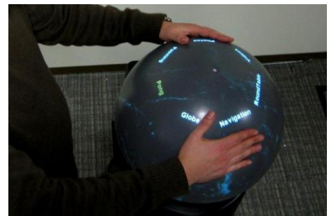
il.3.6-1. Sphere: multidotykowy, sferyczny monitor, Hrvoje Benko, Andrew D. Wilson and Ravin Balakrishnan, http://research.microsoft.com/en-us/um/people/benko/projects/sphere
