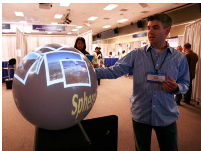
il.3.6-1. Sphere: multidotykowy, sferyczny monitor, Hrvoje Benko, Andrew D. Wilson and Ravin Balakrishnan, http://research.microsoft.com/en-us/um/people/benko/projects/sphere
