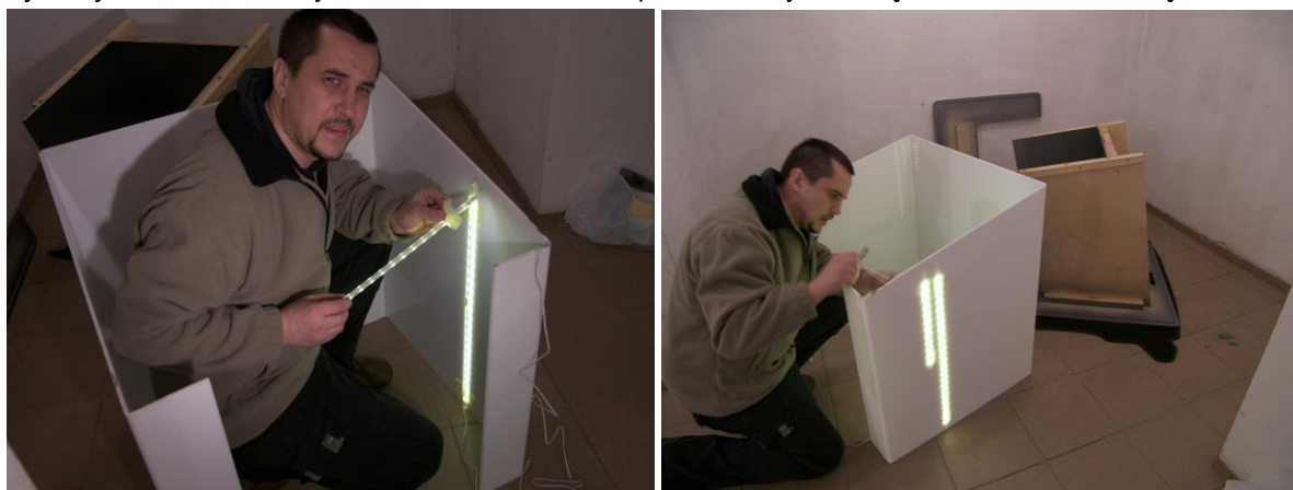
il.4.3.3 / 4. Rozłożona bryła fotela Trapez i testy rozchodzenia się światła pasków diodowych w poliwęglanowej tafli.
