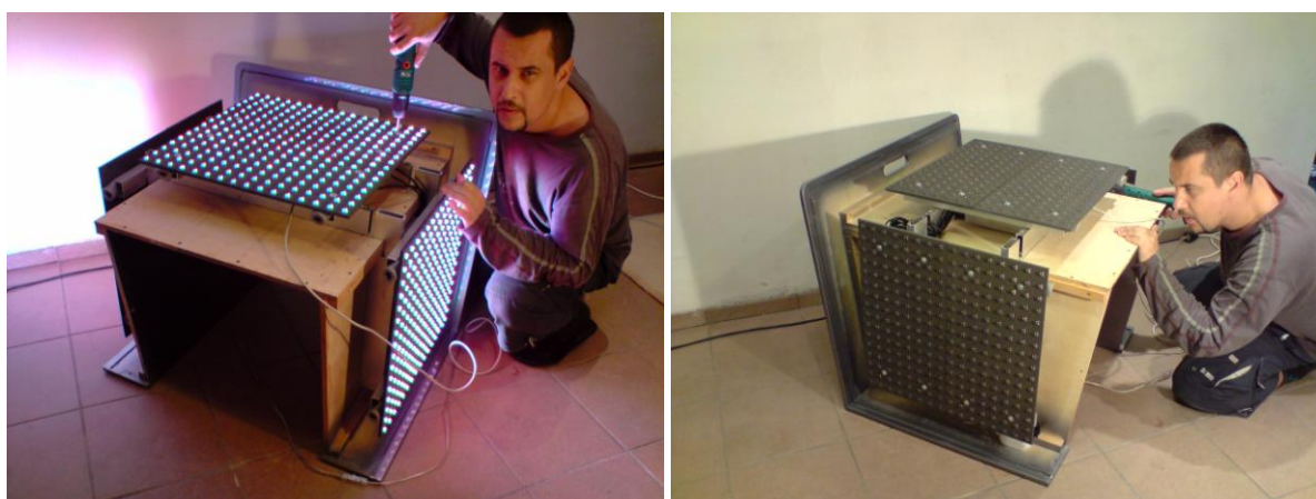
il.4.3.3 / 2. Konstrukcja i panele diodowe stołu z zestawu Trapez
